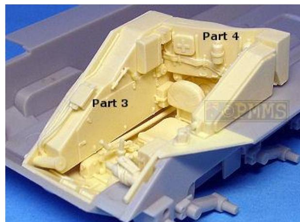
**Deux vues du compartiment conducteur: le résultat sur la maquette et la photo du kit résine. Le plancher est découpé pour permettre une meilleure mise en place. J'ai, malgré tout, rajouté quelques détails supplémentaires mais le kit est déjà magnifique de finesse...**
