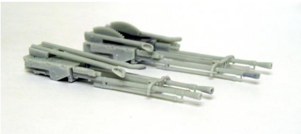
**Les canons sont évidés. J'ai préféré les percer et les affiner plutôt que mettre les cônes de la photo-découpe. Les évacuateurs de douilles sont également perforés...**
