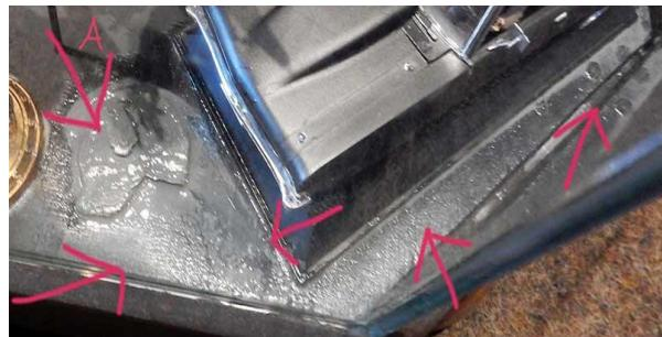
**On voit sur la photo de droite l'endroit où le modèle était collé (A) et la résine a coulé à l'emplacement du socle. Un morceau « mou » est encore en place. La résine répandue est toujours liquide, active, ne séchera jamais et est donc nocive...**
