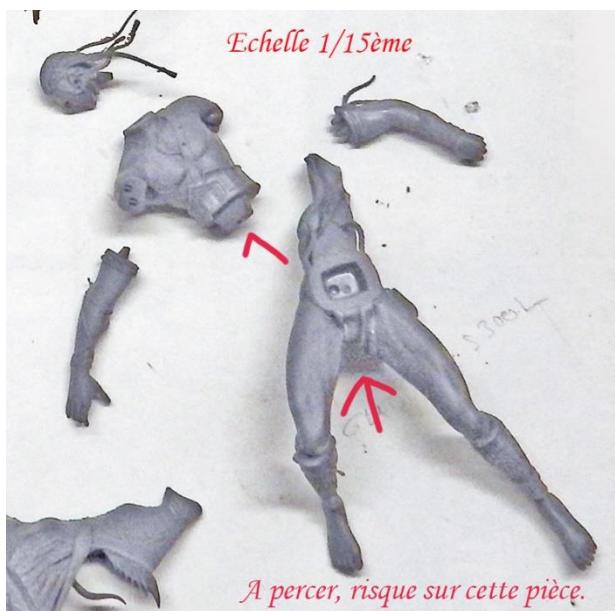
**Le problème a été détecté lors du perçage de la pièce pour la fixer sur un socle avant peinture. La résine liquide s'est écoulée aussitôt...**
