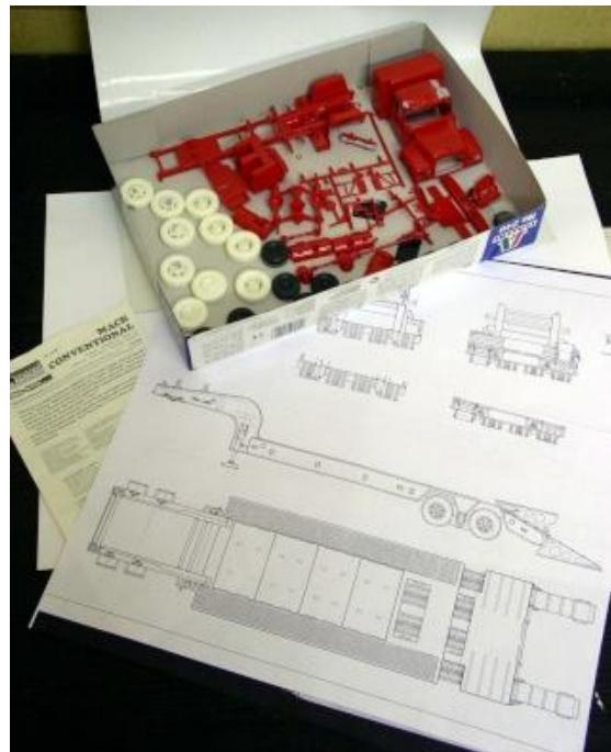
**Le camion est le Mack de la marque Monogram en Snaptite (montage à encliper sans colle). Les demi-roues du kit sont éliminées et remplacées par des modèles plus réalistes en résine...**
