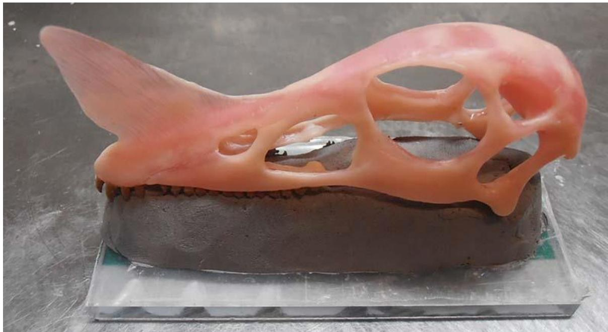
**Le but du précédent tutoriel va être de réaliser un moule en élastomère de silicone en deux parties. La difficulté technique résidant principalement dans le fait que le sujet à mouler est relativement fin et assez délicat à manipuler de par la finesse de la sculpture...**
