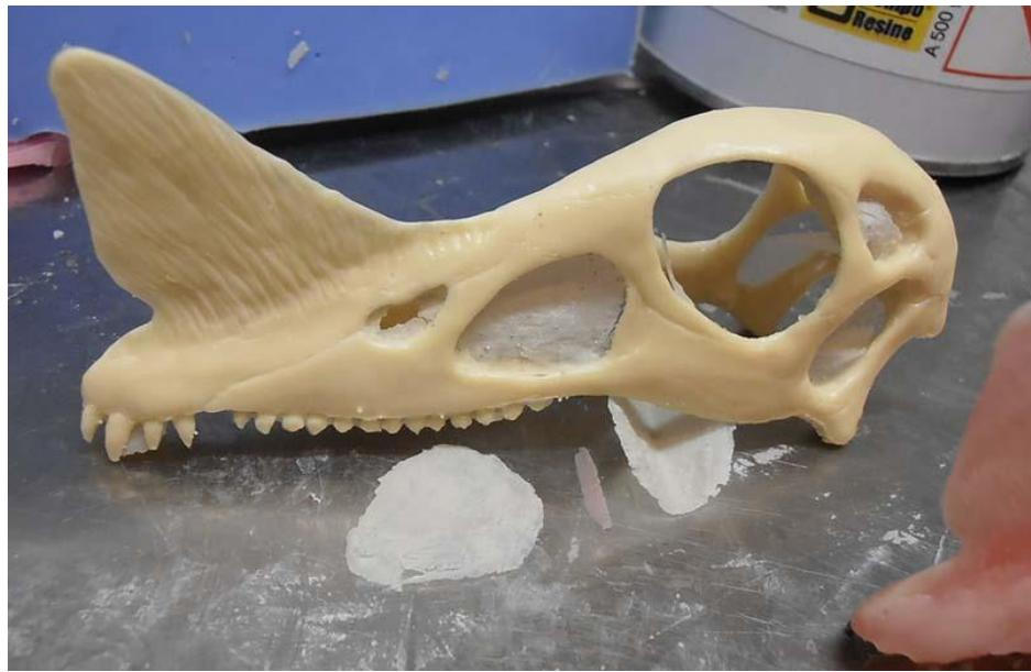
**Les bavures de moulage seront éliminées d'abord au scalpel puis à l'aide de différentes fraises tungstène avec un micro-moteur (du style Dremel)...**
