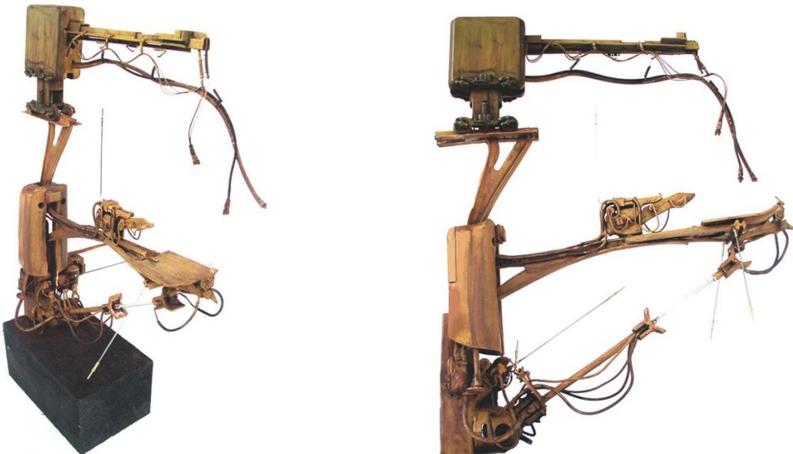
**Il est fabriqué à partir de morceaux de cintre en plastique, des parties de kit main-libre de téléphone portable, des pièces de la boîte à surplus... It's made from pieces of plastic coat hanger, mobile phone hands-free kit parts, surplus box parts...**
