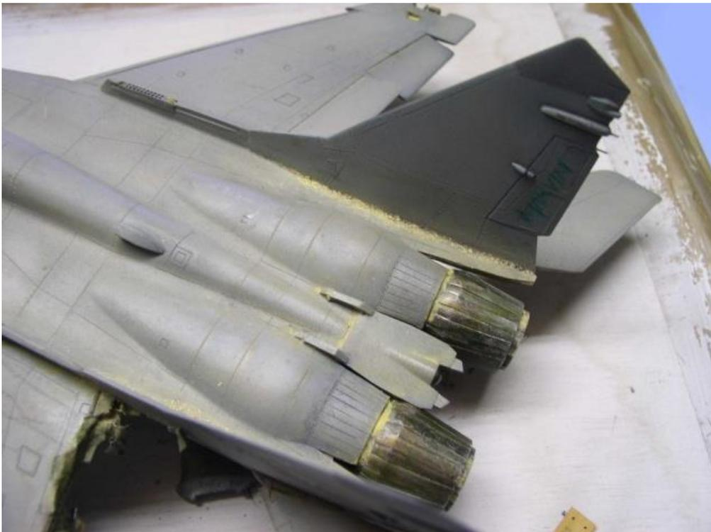
**De la poudre de pastel est déposée dans certains creux et intérieur de trappe, cockpit...**
