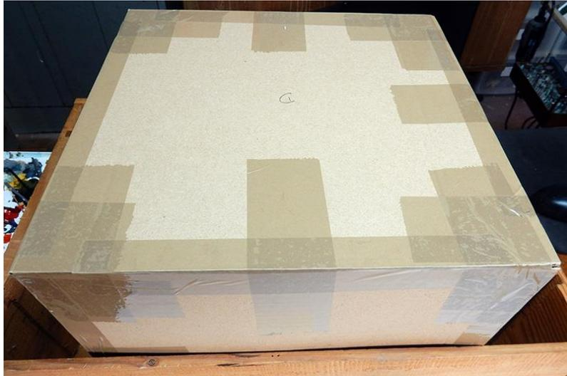
**Important : on confectionne avant un couvercle en carton. La résine ne doit pas recevoir de poussière pendant la phase de durcissement... Ni après d'ailleurs...**
