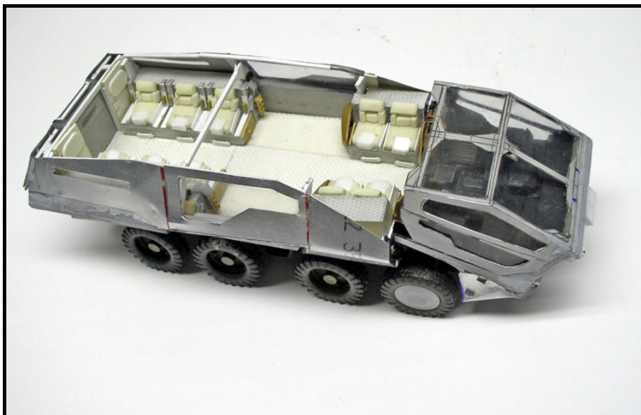
On revient à l'intérieur. Les sièges des passagers sont façonnés en polyester extrudé et collés à la colle à bois...
