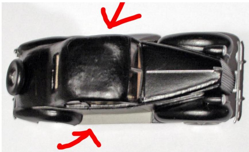
**En effet, sur certains modèles de certaines séries une dégradation s'est opérée se traduisant par des craquelures, des déformations et des écailllements de peinture...**
