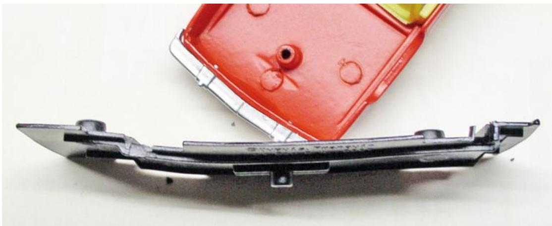
**Ici la T-Bird a le chassis complètement déformé JE PENSE QU'IL EST IMPORTANT DE LES ENLEVER TOUTES DE LEUR SOCLE - tout en les laissant dans leurs boîtes, en supprimant la vis de fixation qui provoque peut-être à la longue une tension qui fait travailler le zamac fragilisé (voir le nombre de chassis déformés alors que la caisse est restée intacte !)...**
